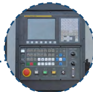
Система управления FANUC Oi Mf(5) Plus
