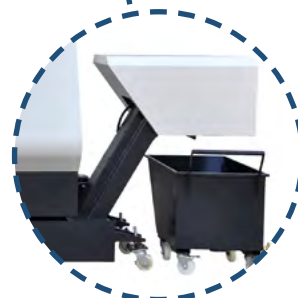
Автоматический конвейер для стружки
