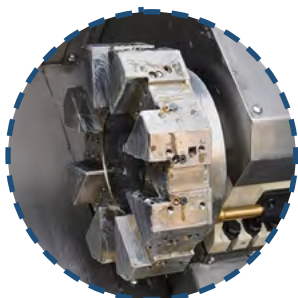
Револьверная головка (без привода)
