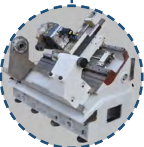
Станина из серого чугуна (Mehanit)
